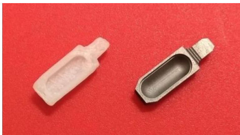
Figura 7. Primeiro modelo da construção da plataforma polimérica (à esquerda) e plataforma original de grafite pirolítico (à direita).
