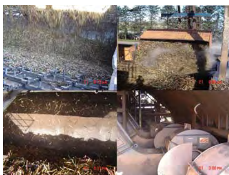
Figura 8: Fotos com detalhes de um sistema de limpeza a seco de colmos de cana-de-açúcar, implantada no Brasil. Fotos Techpetersen (2003).
