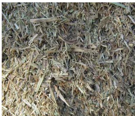
Figura 2: Foto das frações que constituem o palhço e que causam obstrução do sistema rotativo de alimentação das caldeiras. Foto Stupiello (2001).
