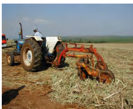
Figura 4: Foto do sistema de enleiramento do palhiço que antecede o processo de recolhimento a granel ou em fardos. Foto Ripoli (2001).
