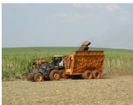
Figura 6: Foto do sistema de colheita integral da cana-de-açúcar e matéria estranha vegetal com o sistema de corte de palmito e limpeza desligado. Foto: Stupiello (2001).
