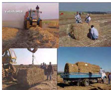
Figura 5: Fotos do sistema de recolhimento com enfardamento do palhicho por sistemas, cilíndrico ou retangular e o mecanismo de manuseio e transporte de carga seca. Foto Ripoli (2003).
