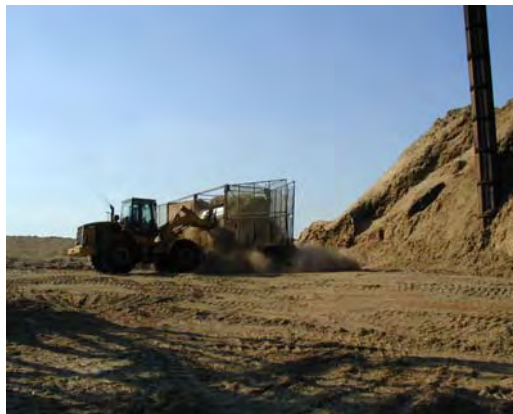
Figura 13: Foto do equipamento de pá carregadora utilizada no sistema de descarregamento do palhiço e no manuseio do material no pátio de bagaço. Foto Stupiello (2001).
