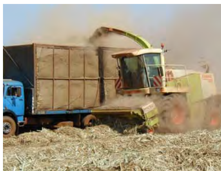
Figura 3: Foto do sistema de recolhimento de palhiço a granel, após enleiramento. Foto: Stupiello (2001).
