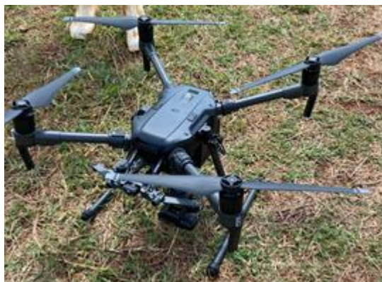
Figura 1 – Modelo de Aeronave Remotamente Pilotada utilizada (Matrice 210 da DJI, China).
