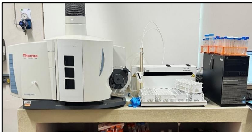
Figura 4 - Equipamento Espectrometria de Emissão Óptica com Plasmas Acoplado (CEA - UNESP)
