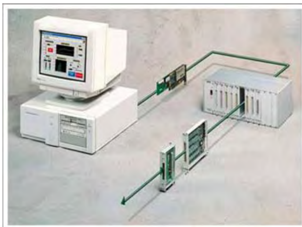
Figura 5.14 - Componentes do sistema DAQ e SCXI para aquisição de dados (NATIONAL INSTRUMENTS, 1998).
