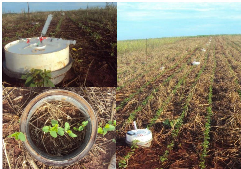
Figura 4. Detalhe das câmaras estáticas de coleta de gases do efeito estufa
