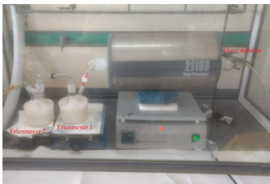
Figura 5. Processo de thermochemistry GC-MS em reator sob fluxo de hélio que encaminha os produtos liberados para os Erlenmeyers contendo clorofórmio.
