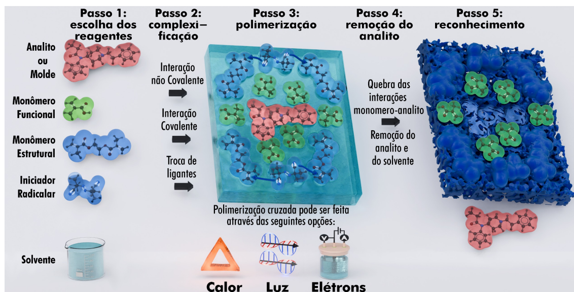
Figura 2.3: Esquematisação do funcionamento de um MIP, no exemplo temos um fentanil como molécula molde [21].
