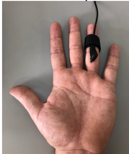
Figura 26 – Conexão do sensor de Temperatura/Resposta Fisiológica
