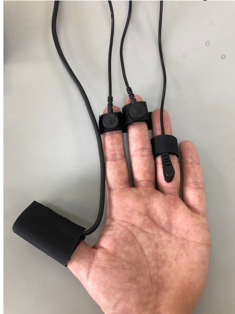
Figura 27 – Conexão dos sensores no participante
