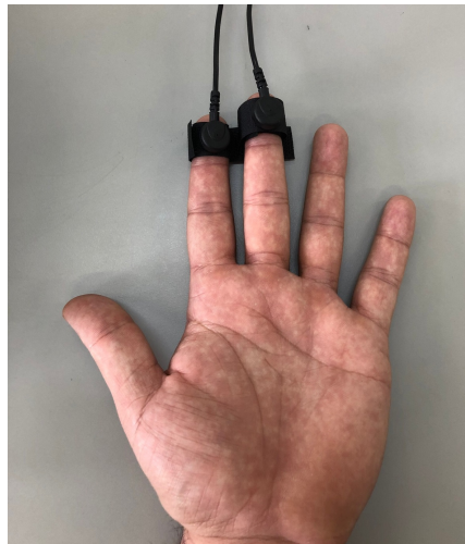
Figura 24 – Conexão do sensor de Resistência Eletrodérmica/Controle de Ansiedade
