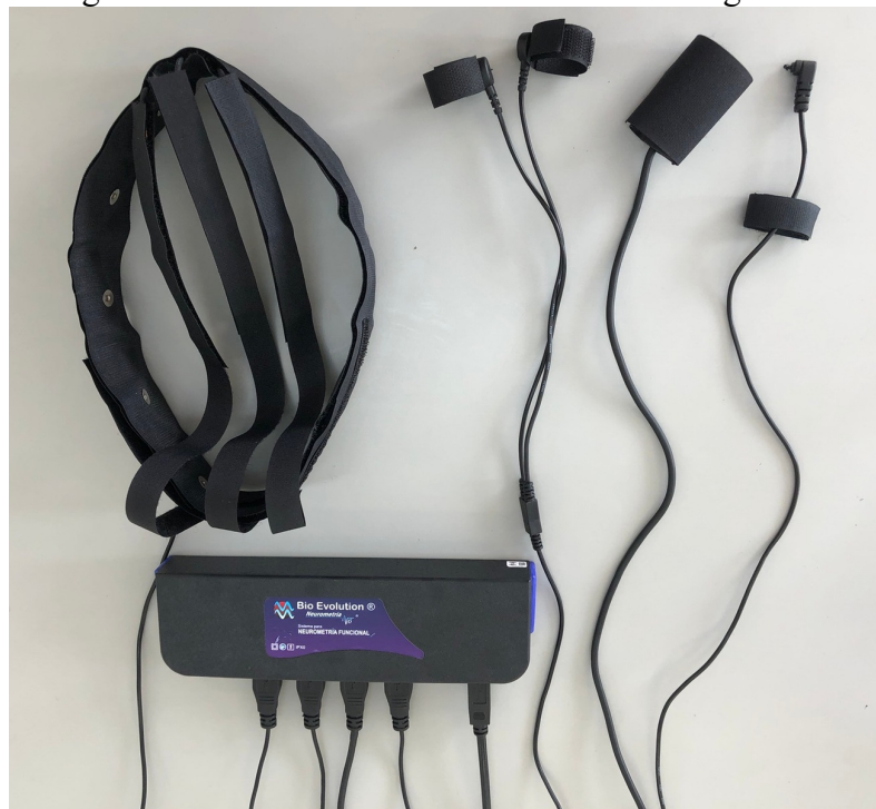
Figura 22 - Sensores conectados nos canais do gabinete
