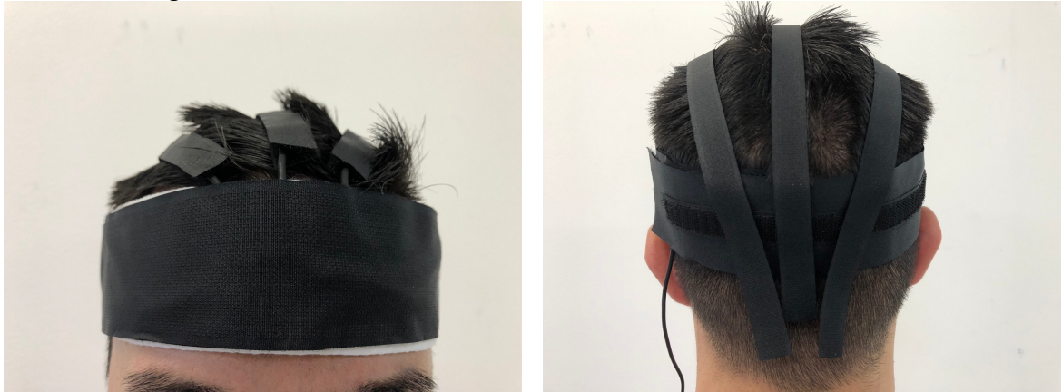
Figura 23 – Conexão do sensor Encefálico/Neurometria Encefálica
