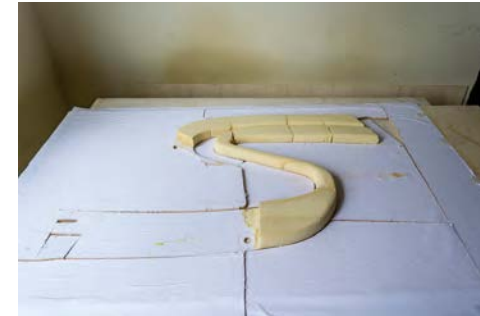
Fig. 57: Aplicação de PU na chapelona de compensado.
