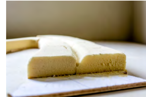
Fig. 61: Aplicação de PU na chapelona de compensado.
