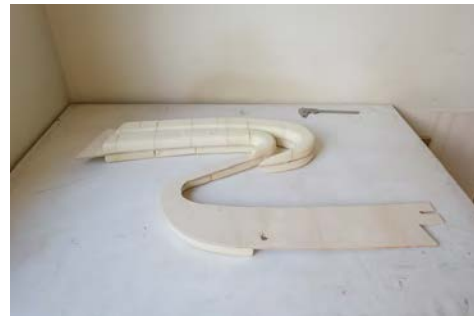
Fig. 59: Aplicação de PU na chapelona de compensado.
