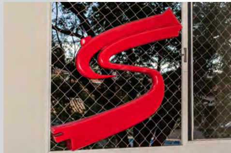
Fig. 70: Mockup após a aplicação da última demão de tinta automotiva.
