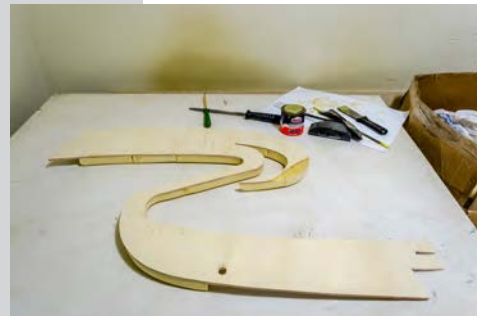
Fig. 58: Aplicação de PU na chapelona de compensado.
