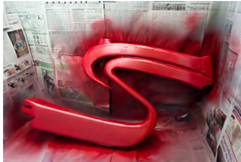
Fig. 68: Aplicação da primeira demão de tinta automotiva.
