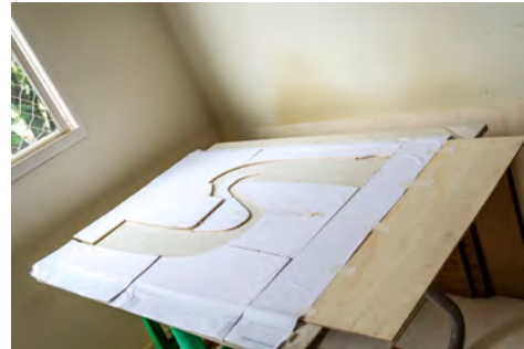
Fig. 56: Corte da chapelona numa placa de compensado de 3mm.
