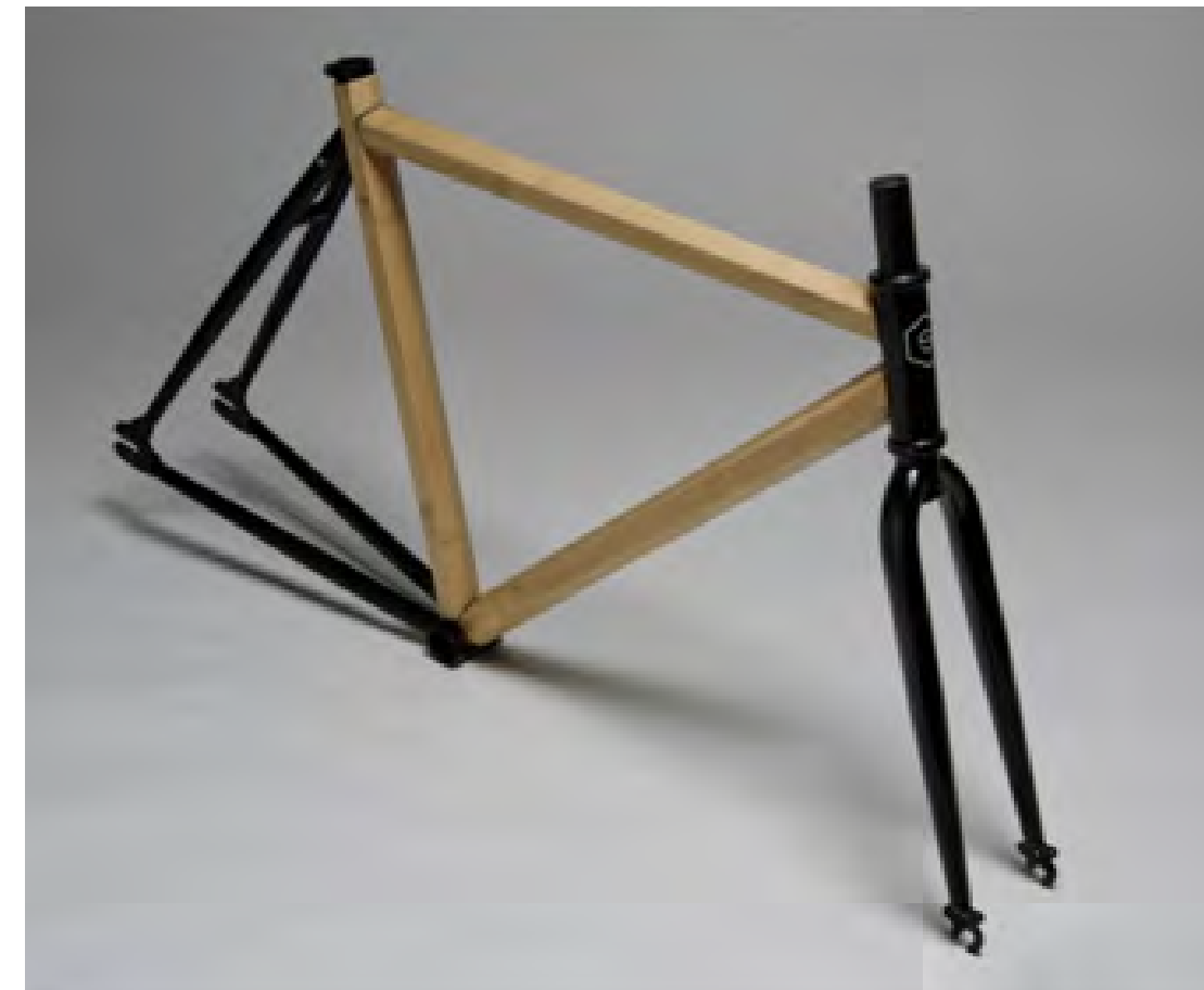
fig. 11: Quadro Hero Bike, feito em laminado de Golden Bamboo.
