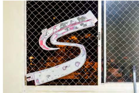
Fig. 69: Segunda correção de imperfeições, após a qual foi aplicada uma segunda demão de tinta automotiva.
