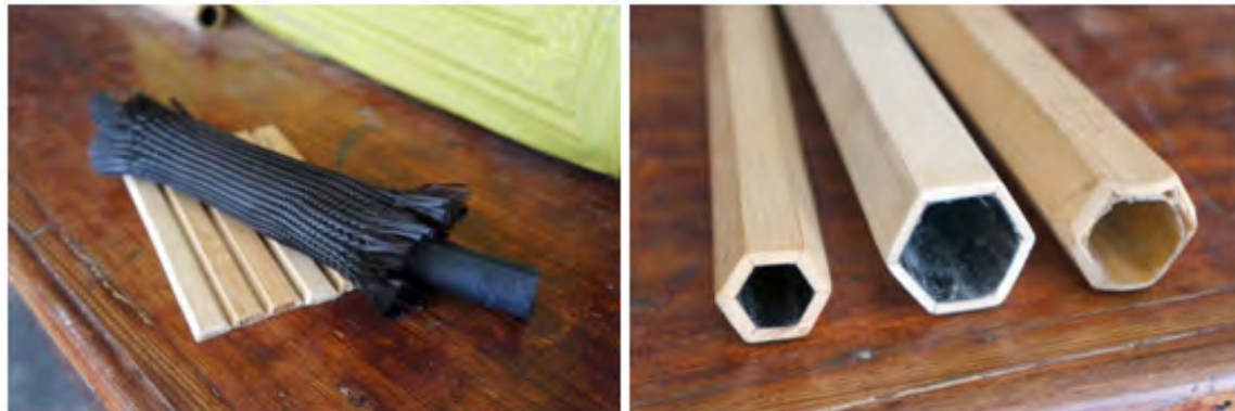
Figs. 12 e 13: Processo de montagem do tubo hexagonal a partir do laminado de bambu e o reforço interno em fibra de carbono.
