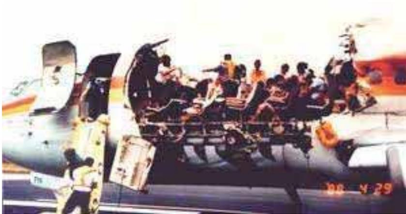
Figura 11 – Fratura por processo de fadiga em um Boeing 737.
