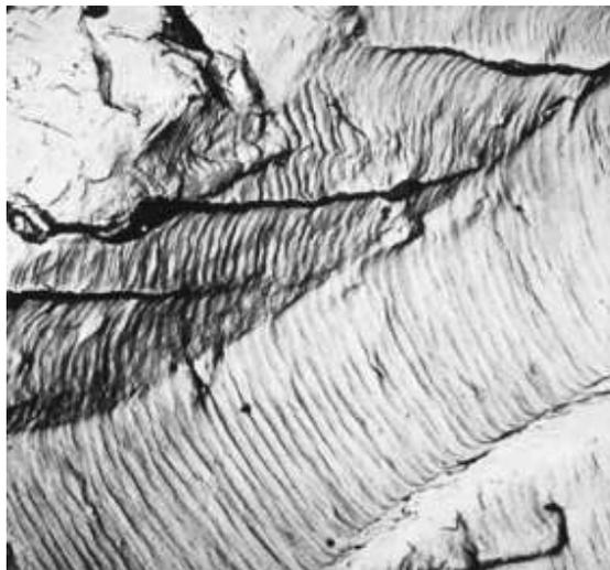
Figura 12 – Morfologia característica do estágio II do processo de fadiga.
