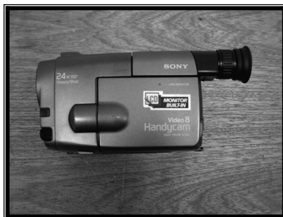
Figura 5 - Modelo da câmera analógica utilizada para visualização da região do gol atingida pela bola.
