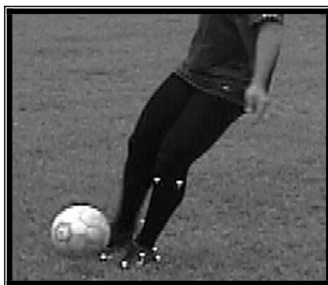
Figura 19 – Quadro que antecede o contato do pé de chute com a bola utilizado para o cálculo da distância Euclidiana entre as coordenadas cartesianas de P1 (calcâneo porção lateral) e o centro da bola.
