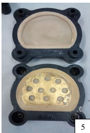
Figura 5- mufla pronta para a confecção dos corpos de prova.
