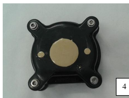
Figura 4- Mufla preenchida com gesso.
