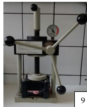
Figura 9- Mufla na prensa hidráulica sob pressão de 1,25 toneladas.
