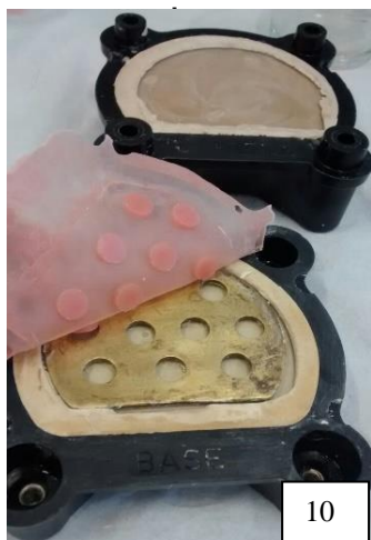
Figura 10- corpos de prova da resina acrílica sendo desincluídas
