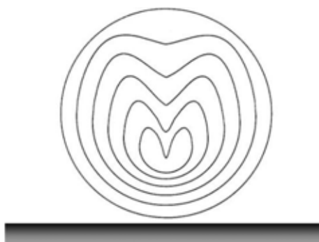
Figura 3 – Formação de um micro jato líquido durante o colapso de uma bolha próxima a uma superfície sólida (SUSLICK e PRICE, 1999).
