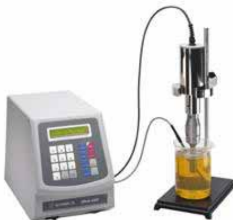
Figura 7 – Representação esquemática da montagem do equipamento Sonics VCX-750 para síntese das amostras.
