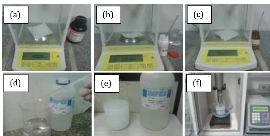
Figura 10 – Passos adotados na síntese das amostras N_ZnO-P, N_ZnO:1Ce e N_ZnO:1Sm. (a), (b) e (c) Pesagem estequiométrica dos reagentes (d) Adição de \text{NH}_4\text{OH} ; (e) Solução resultante após adição do hidróxido de amônio; (f) Solução resultante levada ao processador ultrassônico.
