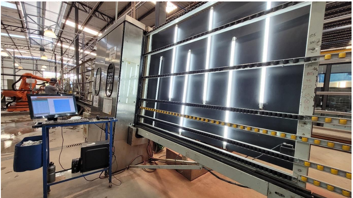
Figura 31 - Lavadora vertical utilizada após o processo de lapidação
