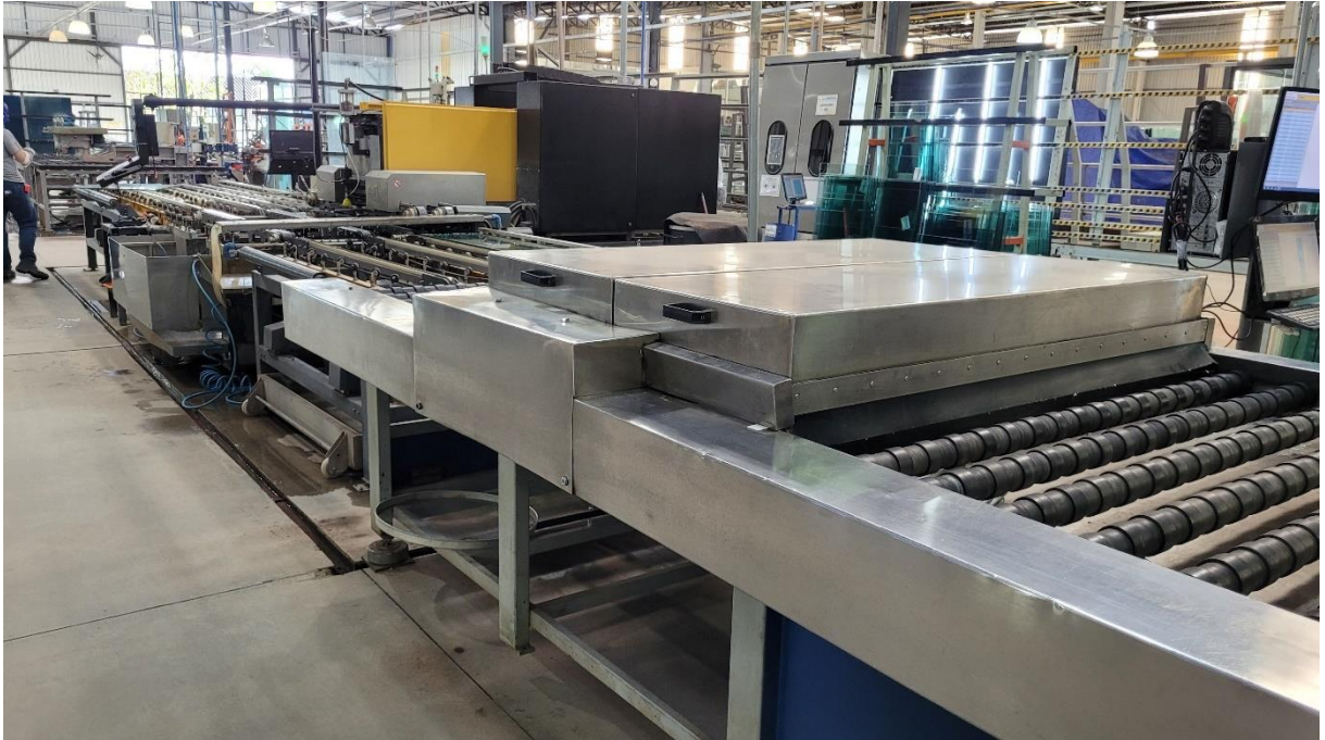
Figura 32 - Lavadora horizontal utilizada após o processo de furação
