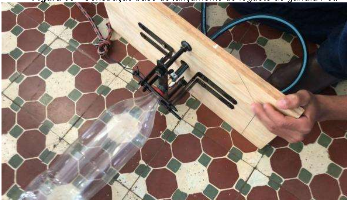
Figura 09 - Construção base de lançamento do foguete de garrafa Pet.
