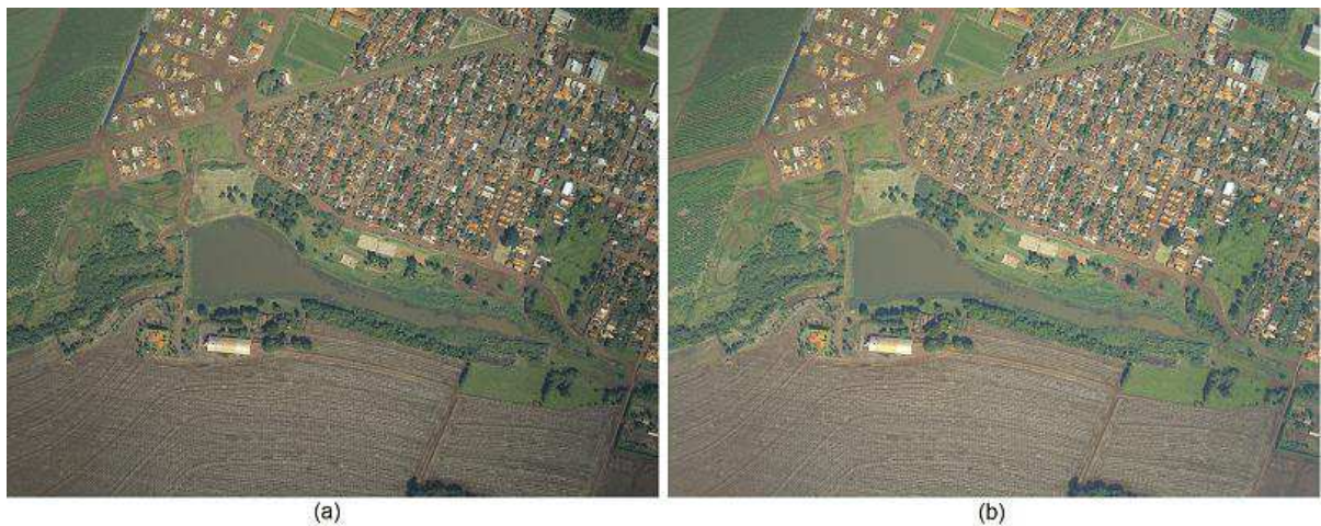
Figura 18. Correção do efeito vinhete na segunda estratégia. (a) Imagem no espectro do visível. (b) Imagem convertida após o ajuste com o valor máximo do polinômio aplicado ao componente I.
