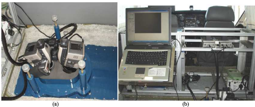
Figura 10. Estrutura do SAAP. (a) Plataforma de coleta. (b) Unidade de controle e alimentação. Fonte: adaptada de Ruy et al. (2007).
