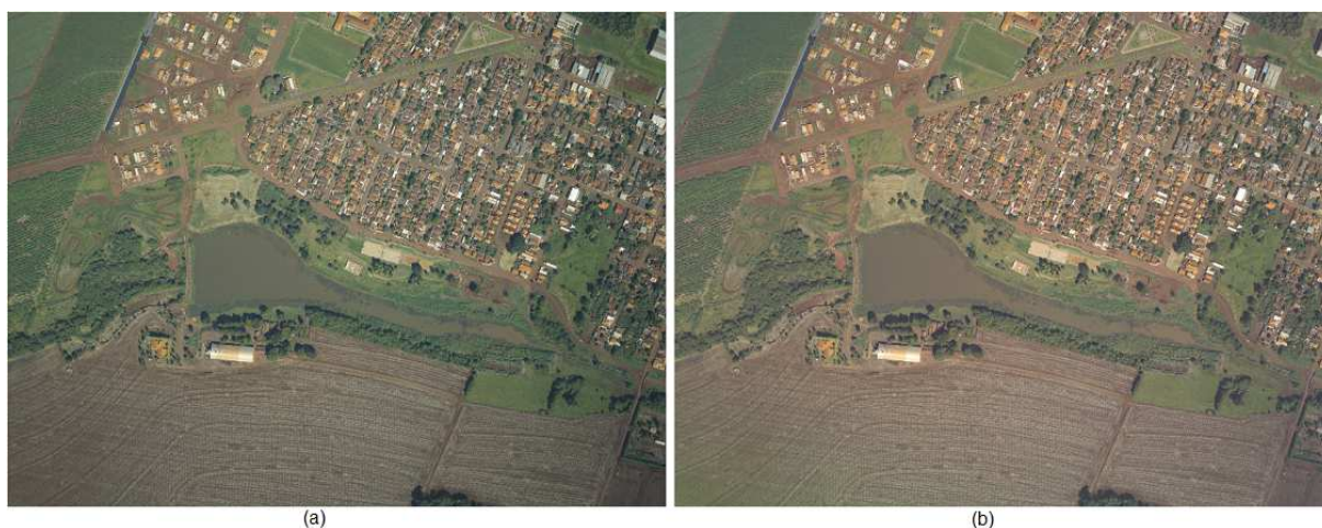
Figura 16. Correção do efeito vinhete na primeira estratégia. (a) Imagem no espectro do visível. (b) Imagem ajustada com o valor máximo do polinômio aplicado aos componentes R, G e B.
