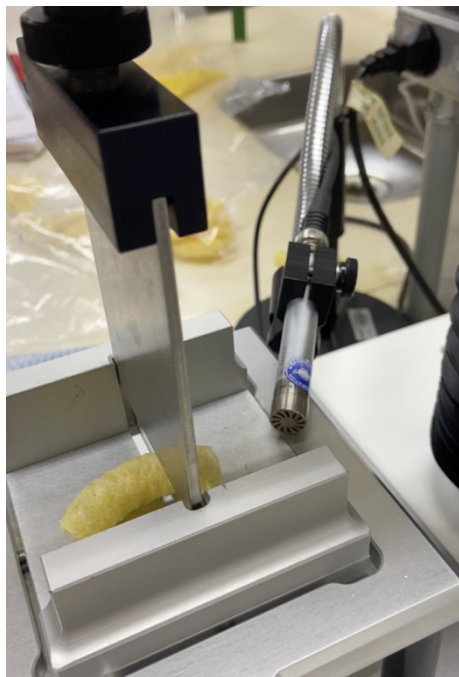
Figura 2 - Texturômetro com probe Blade set com guilhotina acoplado com Acoustic Envelope Detector .
