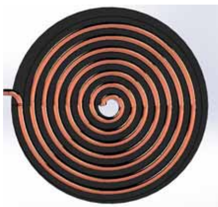
Figura 3 – Concepção física do elemento IPT com indutor espiral cilíndrica.
