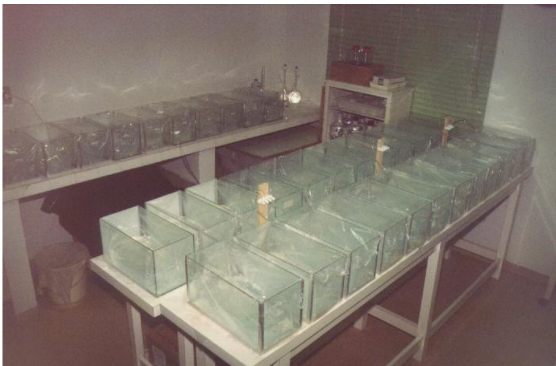
Figura 1. Estrutura dos aquários utilizados no teste de toxicidade aguda para alevinos de O. niloticus , variedade tailandesa, expostos ao Hg, São Paulo, 2003
