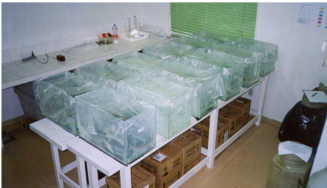
Figura 1. Estrutura dos aquários utilizados nos testes de toxicidade crônica em O. niloticus , variedade tailandesa, exposta ao Hg São Paulo, 2003
