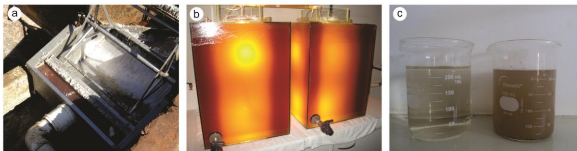
Figura 3. Efluente industrial de pescado utilizado para o tratamento com Rubrivivax gelatinosus (a); cultivo biotecnológico de R. gelatinosus em efluente para o tratamento e obtenção de biomassa (b); comparação entre efluente antes (direita) e depois (esquerda) do tratamento com R. gelatinosus (c).
