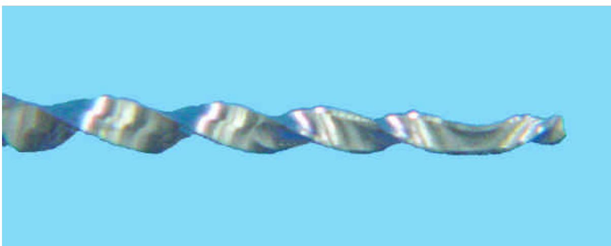
Vista mais aproximada da ponta do instrumento F 3 após ensaio de torção. Distorção e deformação das espiras adjacentes ao ponto da fratura torcional.
