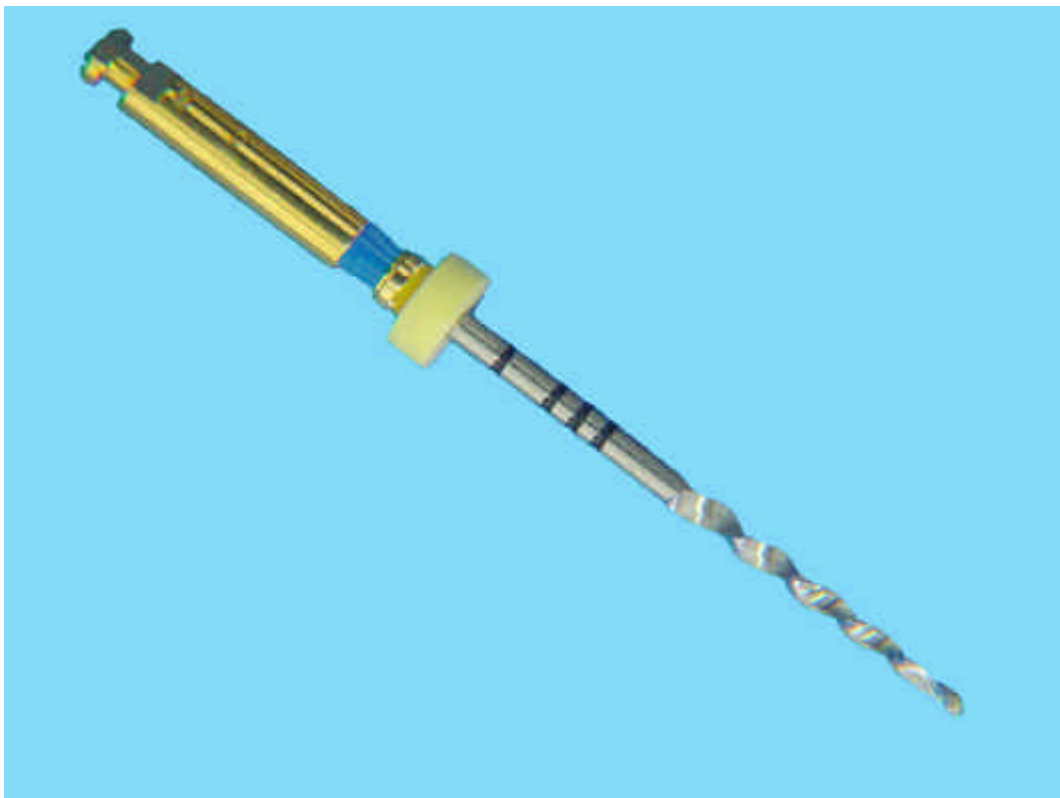
Instrumento Protaper F 3 fraturado após ensaio de torção. Distorção e deformação das espiras adjacentes ao ponto de fratura torcional.
