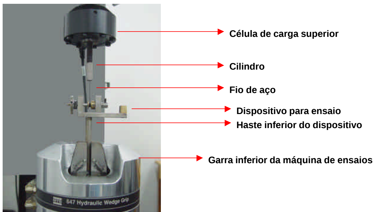
FIGURA 10: Dispositivo acoplado à máquina de ensaios pela sua haste inferior.
