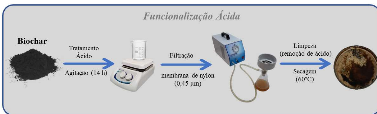
Figura 16 – Esquema de funcionalização ácida do Biochar através do processo de oxidação química com solução sulfonítrica (1:3 v/v), filtração com membrana de Nylon e secagem do material obtido.
