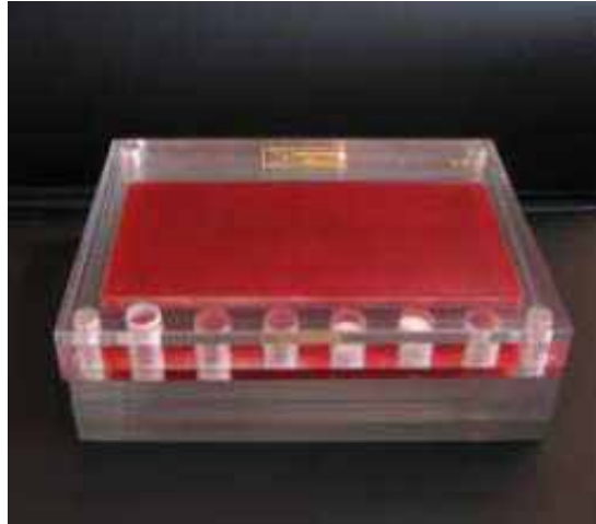
Figura 4: Imagem do fantoma de mama e objetos de testes inseridos nele [15].
