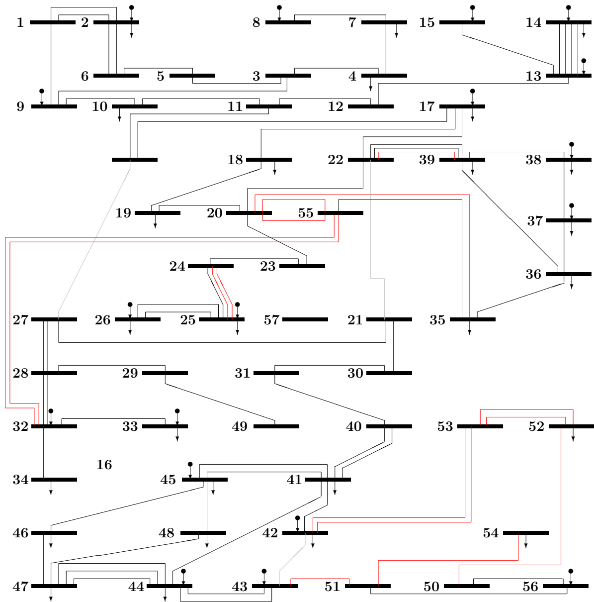
Figura 49 – Plano ótimo de expansão do sistema Boliviano de 57 barras com DOLT
