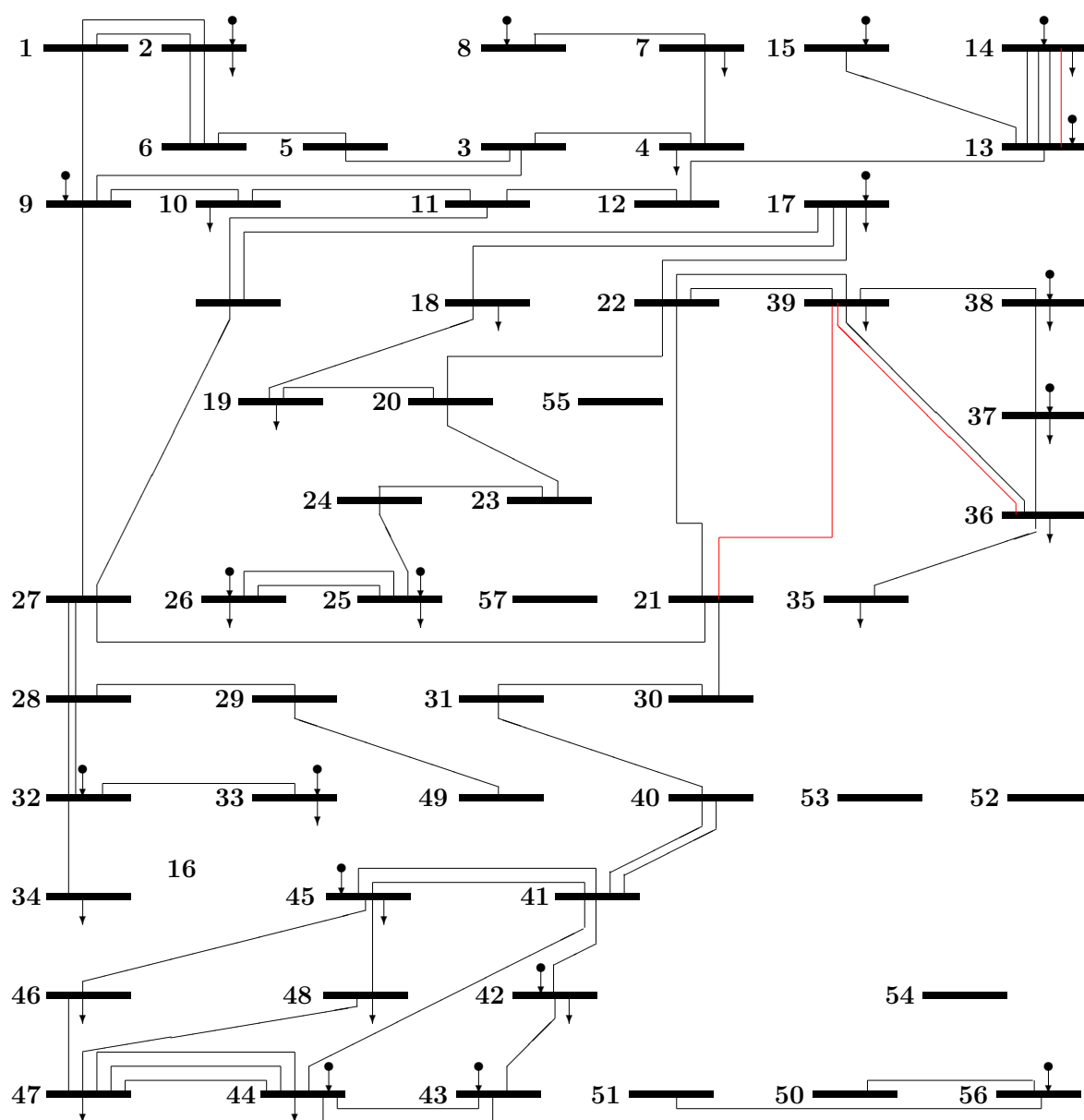
Figura 50 – Plano ótimo de expansão do sistema Boliviano de 57 barras no estágio 1
