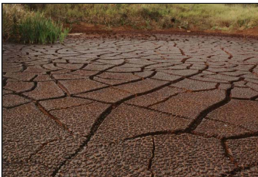
Figura 13. Aspecto do lodo durante o processo de secagem, nas lagoas de secagem de lodo, da ETA II município de Rio Claro, SP.
