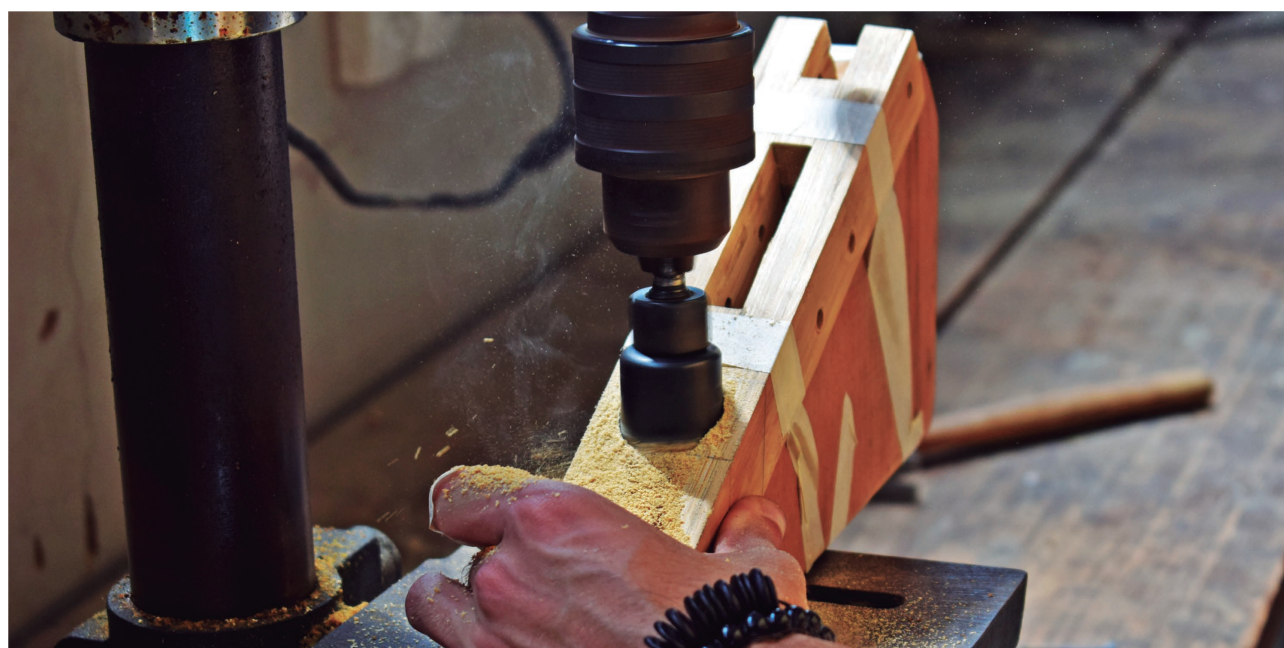
Figura 23 - Perfuração em serra copo com auxílio de gabarito.
