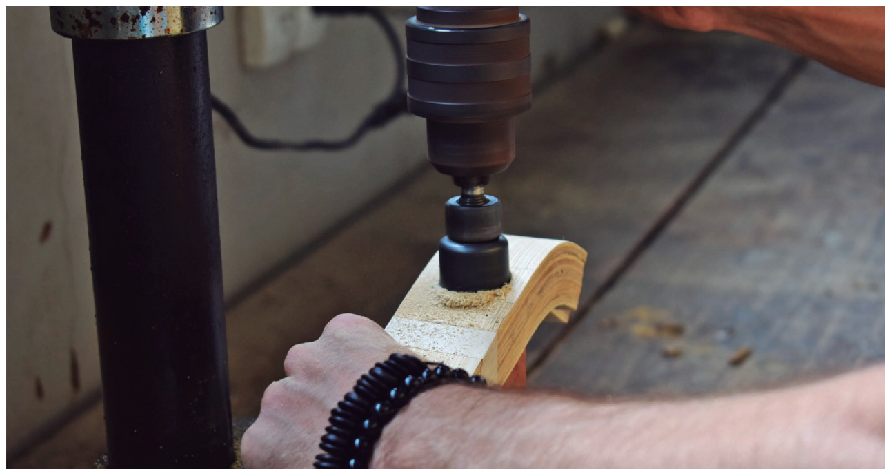
Figura 28 - Perfuração para passagem do canote do selim.
