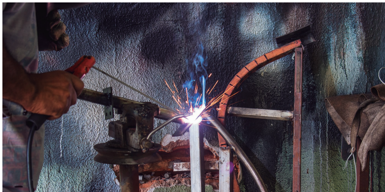
Figura 32 - Soldagem entre chapa e tubo do canote do selim.
