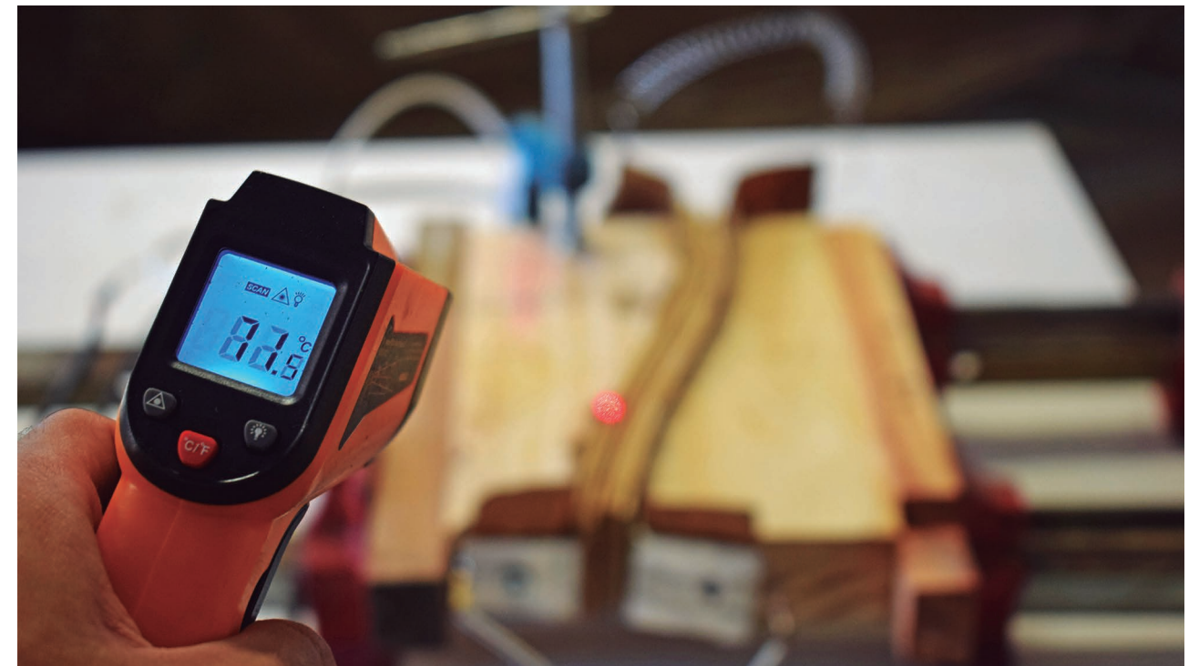
Figura 26 - Verificação da temperatura do molde com o lasergríp.
