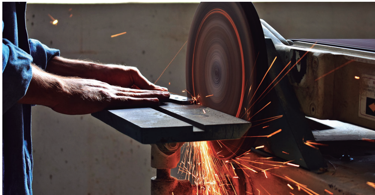
Figura 31 - Usinagem dos engates do quadro.
