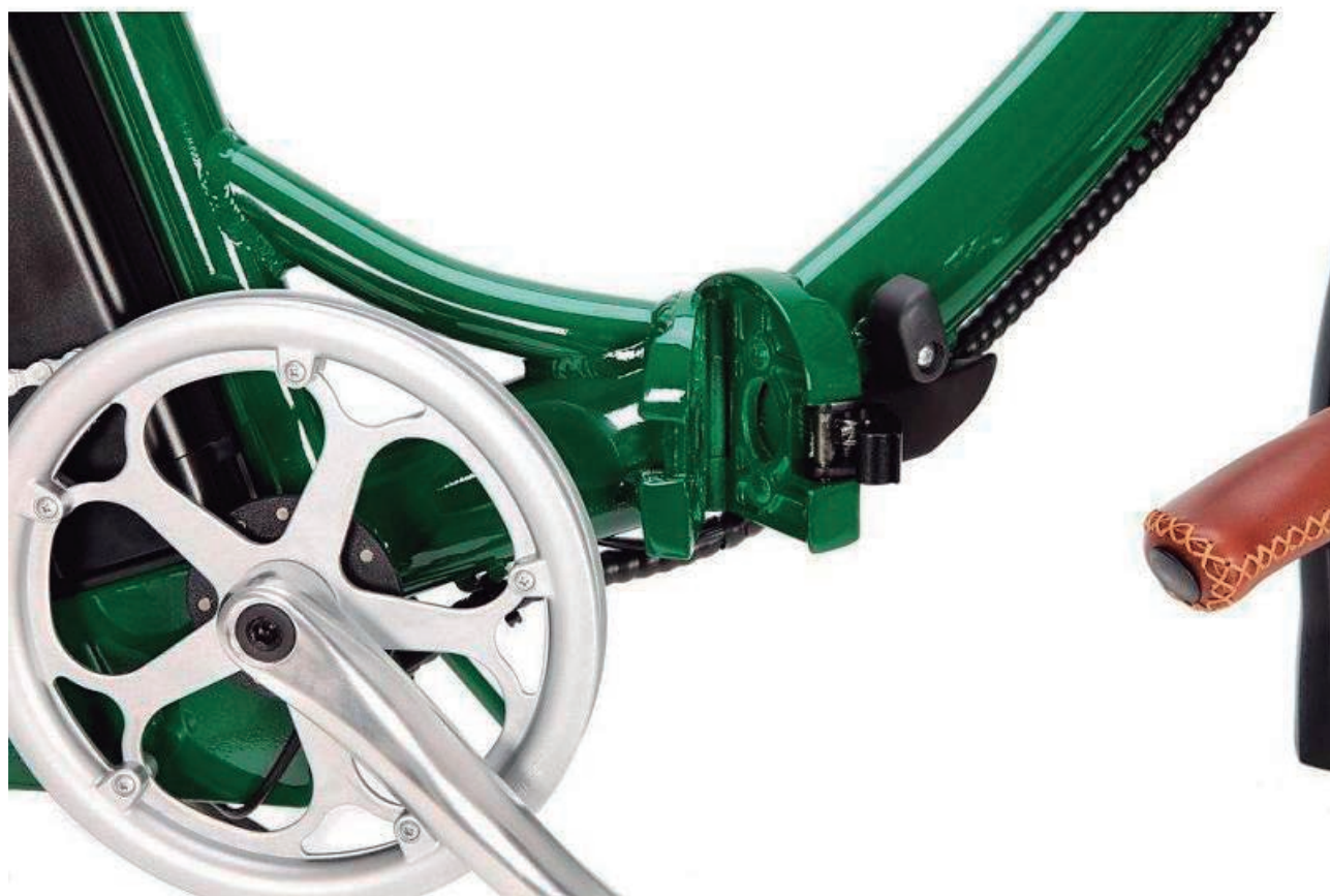
Figura 2 - Detalhe do sistema de dobragem do modelo Vika + da marca Blix. Fonte: oregon-ebikes.com
