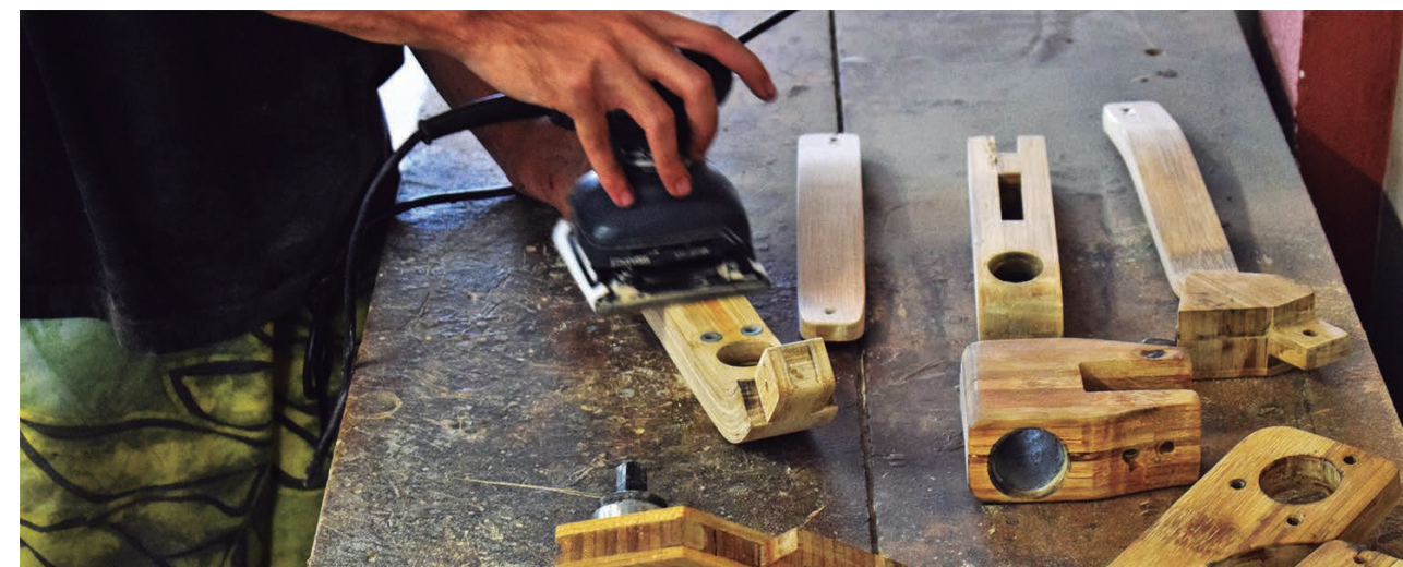
Figura 29 - Lixamento das peças com lixadeira orbital.
