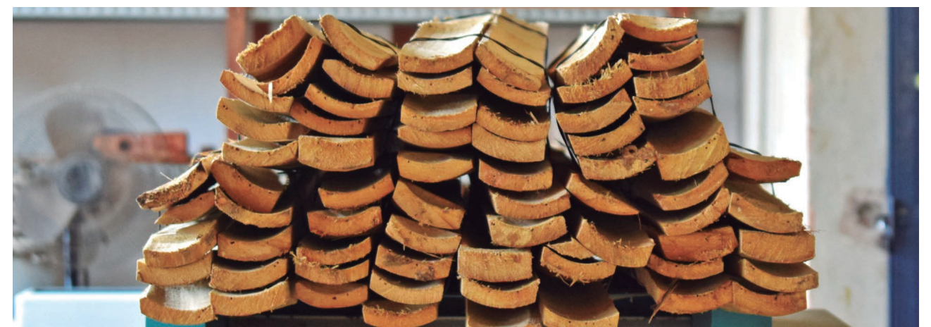
Figura 20 - Ripas de bambu após o desdobro longitudinal.
