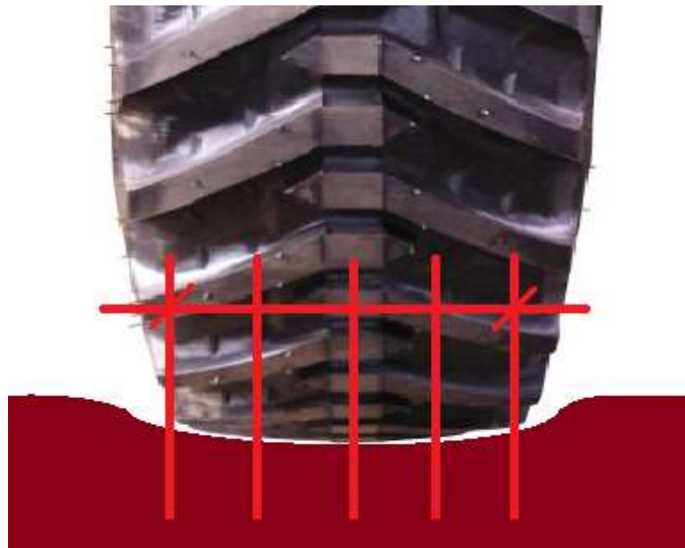
FIGURA 7. Representação das cinco subamostras retiradas em transepto, totalizando largura 55 centímetros.
