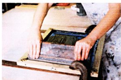
4. Pressionando-se o rodo, começa a impressão
