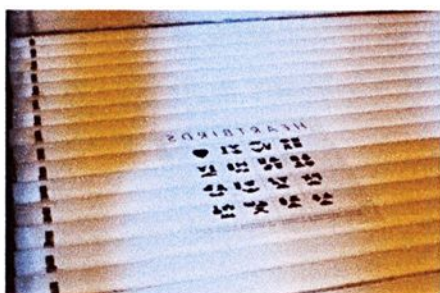
3. O diapositivo é colocado sobre a mesa de gravação
