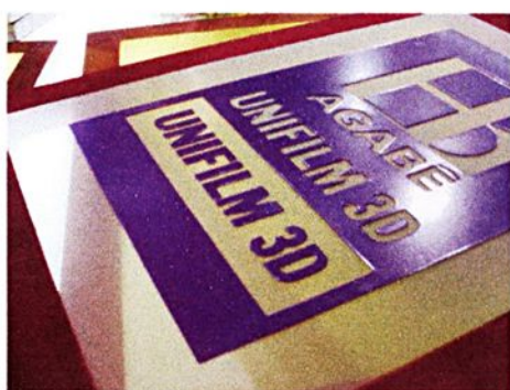
Figura 30. Tela gravada com emulsão 3D Fonte: Arquivo Agabê
