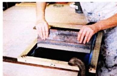
3. Cobre-se a imagem a ser impressa com o rodo, sem pressão
