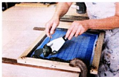
2. A tela é fixada à mesa e o engobe é depositado sobre a tela
