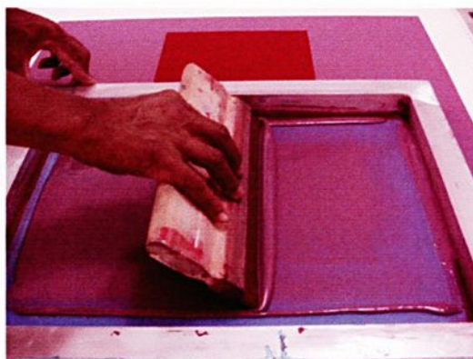
2. A cobertura de tinta sobre a tela deve ser bem espessa de modo a preencher o espaço do relevo
