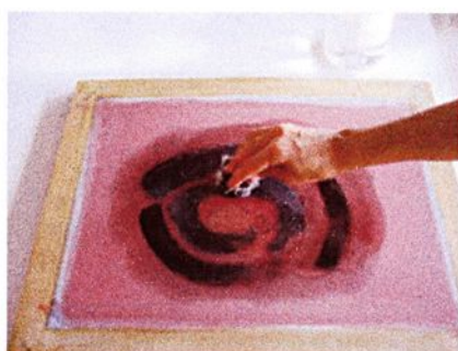
3. Com a estopa embebida em solvente retira-se completamente o tusche
