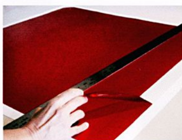
2. Retira-se a película da parte que não será gravada
