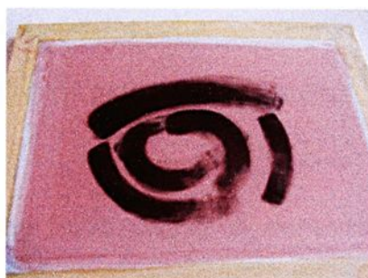
2. Aplica-se uma camada de emulsão dos dois lados da tela
