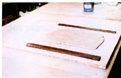
1. Guias de madeira são dispostas ao lado da placa de argila para nivelar a tela
