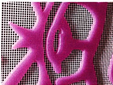
Figura 32. Tela gravada com emulsão 3D (detalhe) Fonte: Arquivo Agabê
