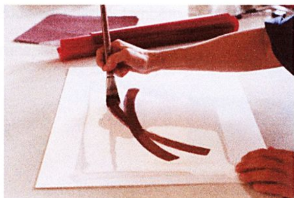
Aplicação de abdeck com pincel sobre acetato
