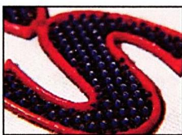
Figura 24. Impressão alto relevo com plastisol Fonte: Arquivo Agabê
