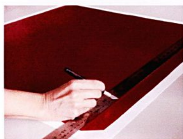
1. Para recortar o filme utiliza-se uma faca de corte e régua de aço
