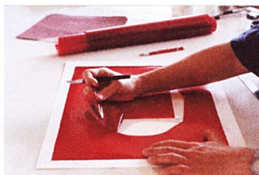
2. Retira-se a película recortada, deixando-se as áreas correspondentes ao desenho
