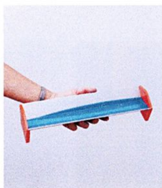
1. A emulsão previamente misturada ao sensibilizante é colocada no aplicador
