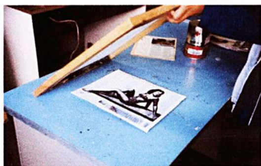
1. O laser filme impresso é colocado sob uma tela limpa de serigrafia.
