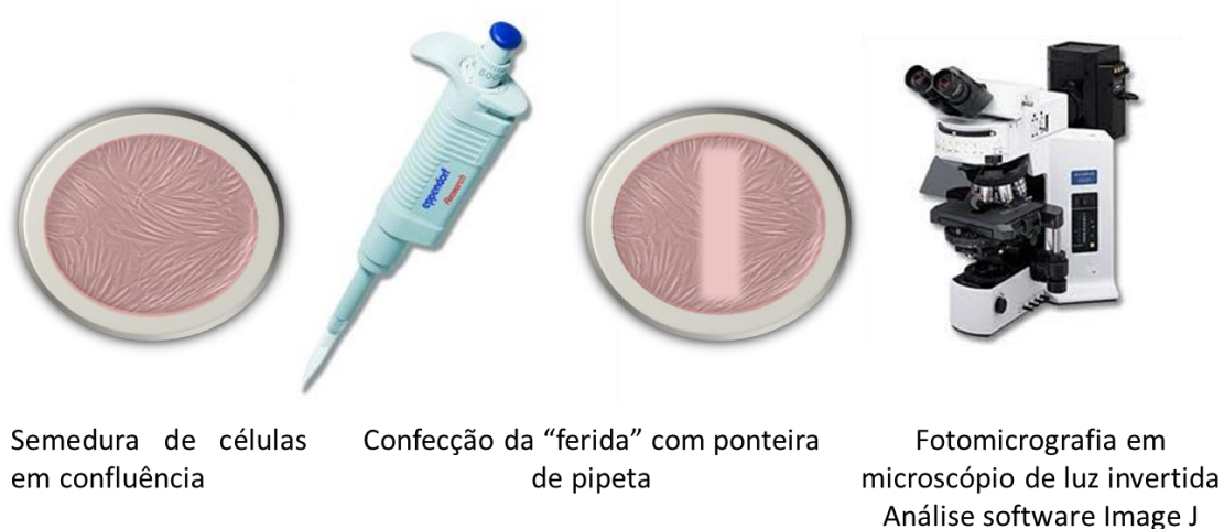
Figura 10 - Esquema representativo do ensaio de migração celular pelo teste de Wound Healing.
