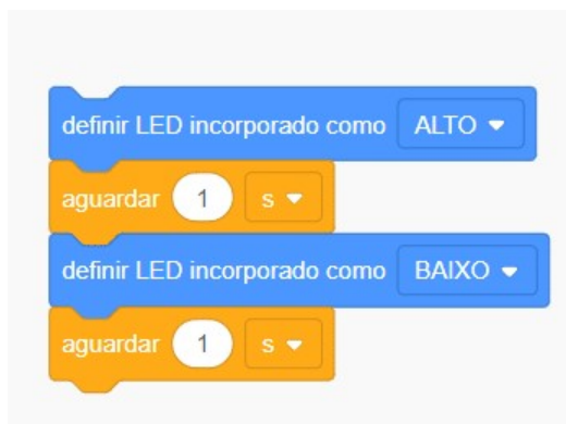
Figura 2.4 – Programa em blocos para fazer o LED incorporado piscar
