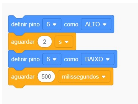
Figura 2.5 – Programa para piscar um LED no pino 6
