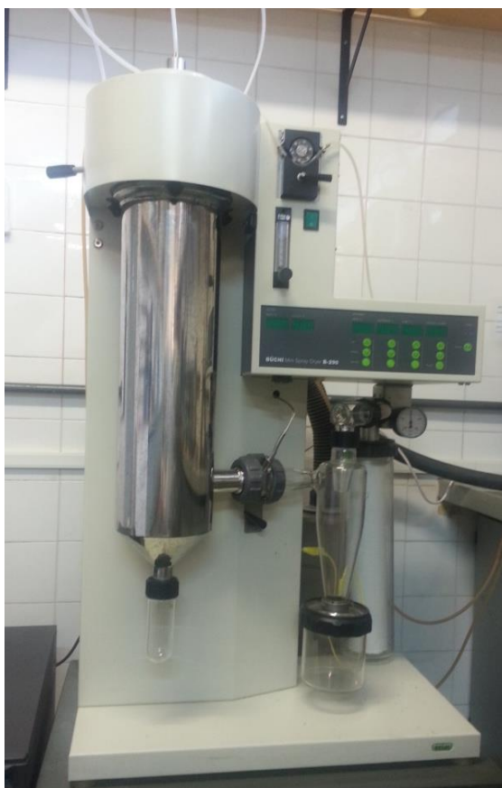
Figura 4.1. Spray dryer utilizado na obtenção das microcápsulas.
