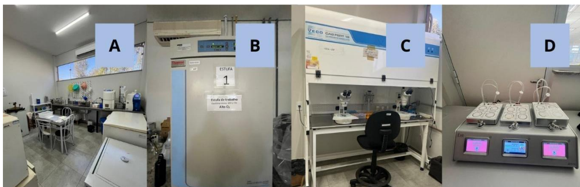
Figura 2 - Ambientes destinados à produção in vitro de embriões. A. Sala de aspiração folicular. B. Incubadora de alto O 2 . C. Fluxo laminar. D. Incubadora de baixo O 2 .
