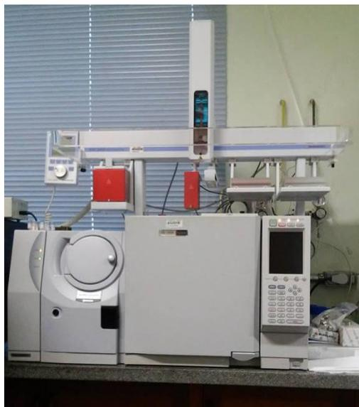
**Figura 8.** Cromatógrafo Shimadzu QP- 2010 a gás acoplado á massas utilizado nas análises
