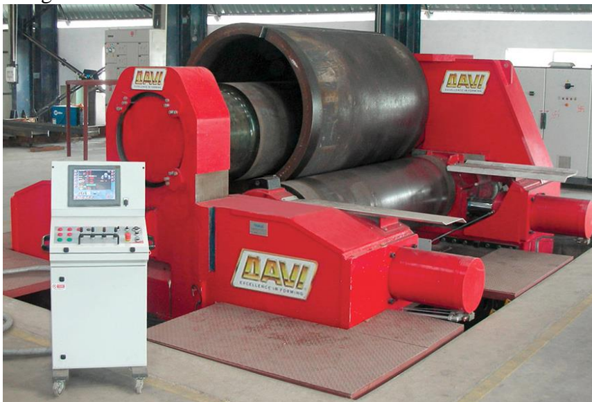
Figura 3 - Calandra de 3 rolos com cilindro conformado.
