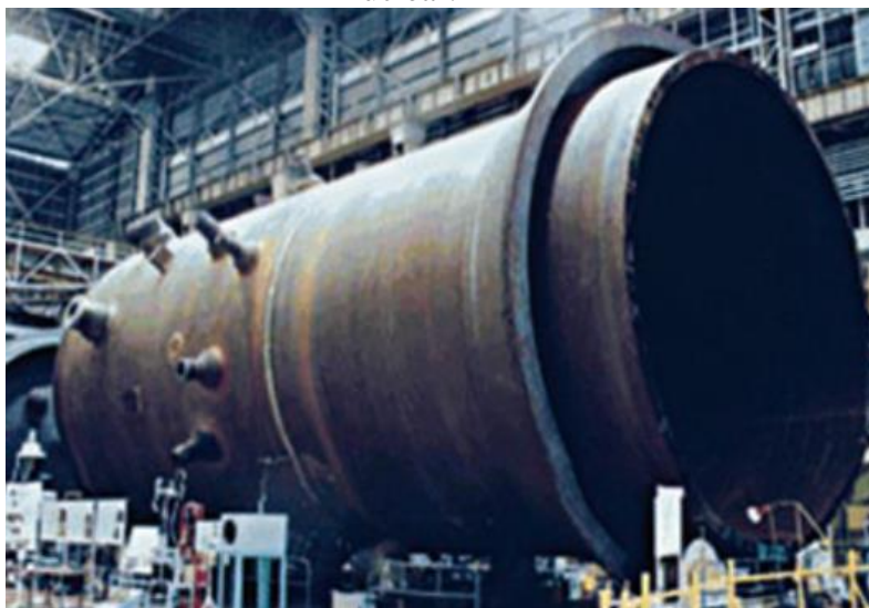
Figura 4 - Vaso de pressão de paredes compostas utilizado na construção de um reator nuclear.
