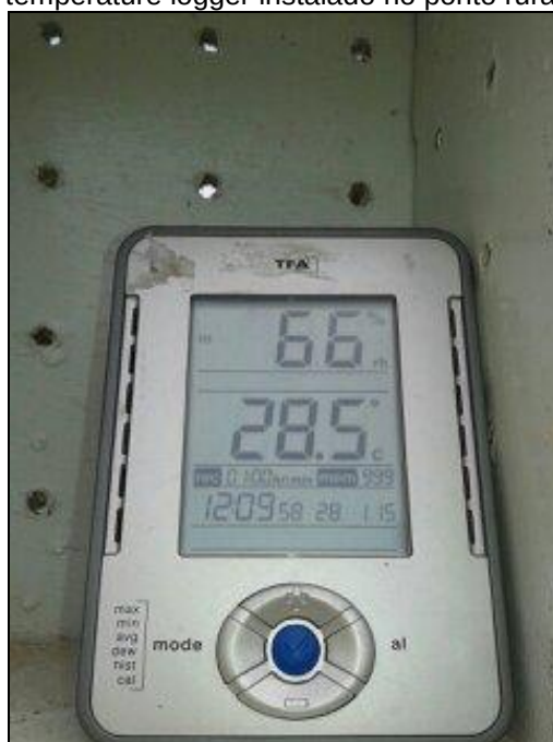
Figura 2 - Registrador automático de temperatura e umidade relativa do ar do tipo Humidity-temperature logger instalado no ponto rural
