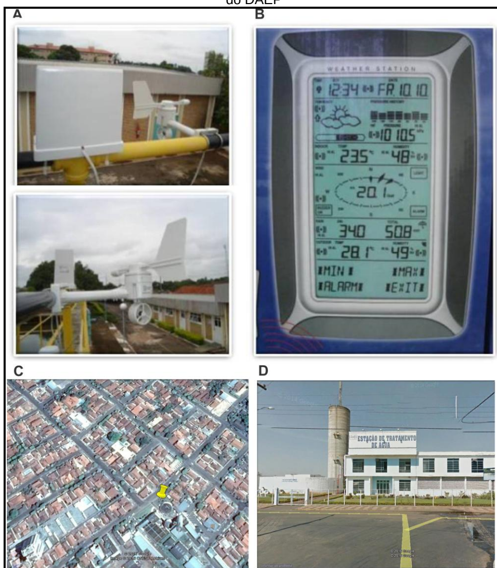
Figura 23 - Ponto urbano – estação meteorológica automática da DAEP. Em (A) tipo de sensor utilizado, em (B) display do sensor, em (C) localização na imagem do Google Earth e em (D) fachada do DAEP
