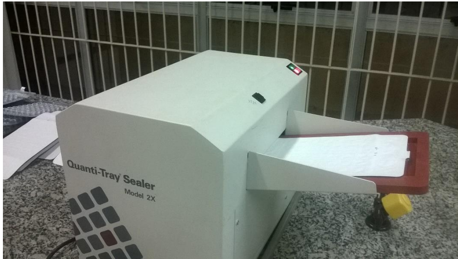
Figura 2. Seladora Quanti-Tray para lacre das placas.
