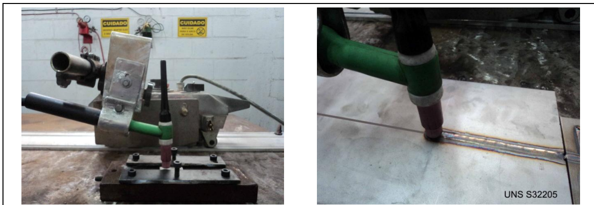
Figura 25 - Sistema de soldagem GTAW automatizado
