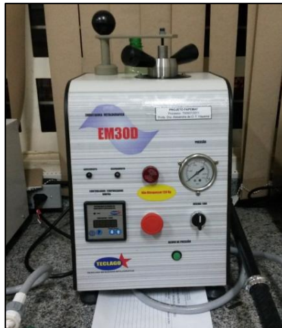
Figura 28 - Prensa de embutimento a quente Teclago EM30D
