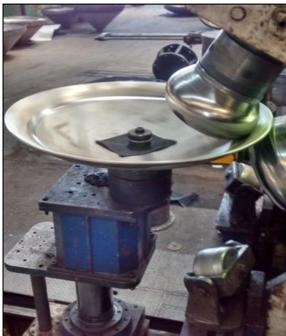
Figura 4 - Processo de rebordeamento de um tampo
