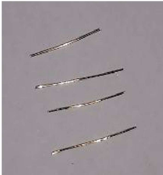
Figura 3- Fibras retas usadas no UHPC.
