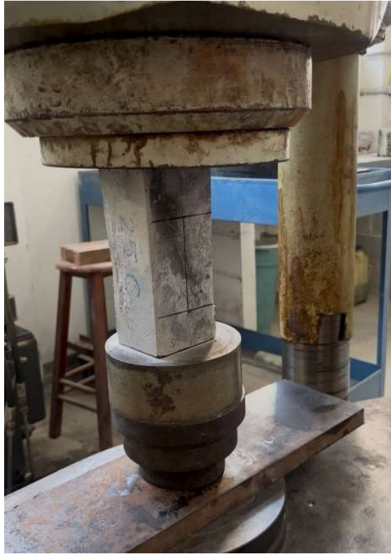
Figura 12- Ensaio de cisalhamento inclinado na máquina.
