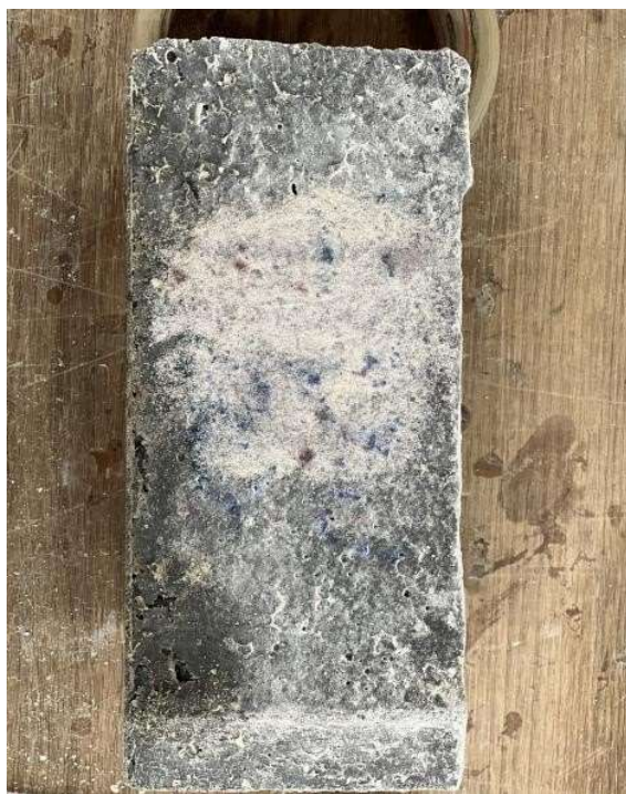
Figura 10- Ensaio da mancha de areia corpo de prova 01.
