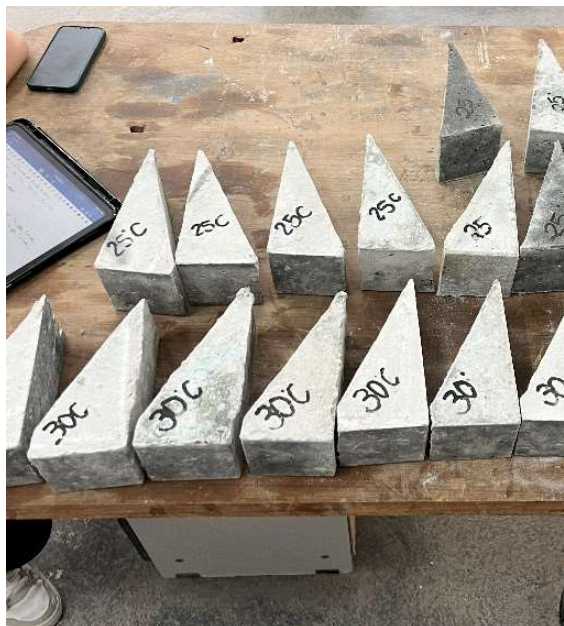
Figura 7- Corpos de prova de concreto C1 inclinados.
