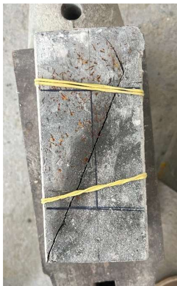
Figura 17- Ruptura típica dos modelos com interface de 25° e 30° sem cola adesiva.
