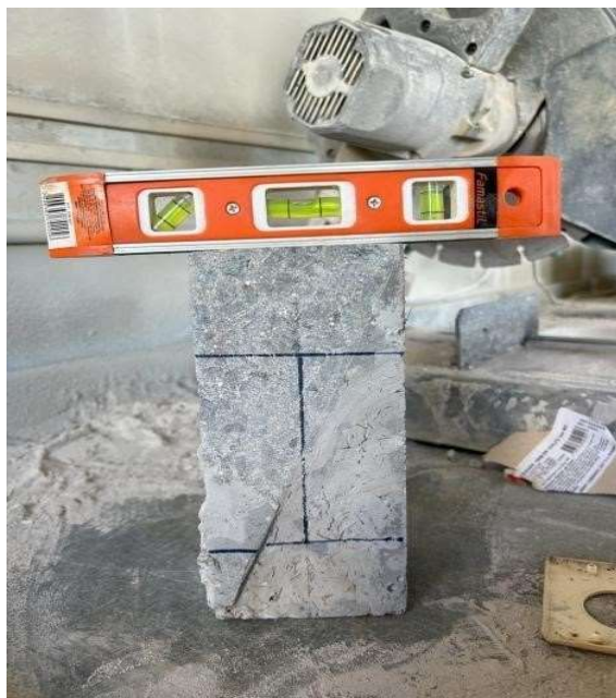
Figura 13- Aferição da retífica pelo nível de bolha.
