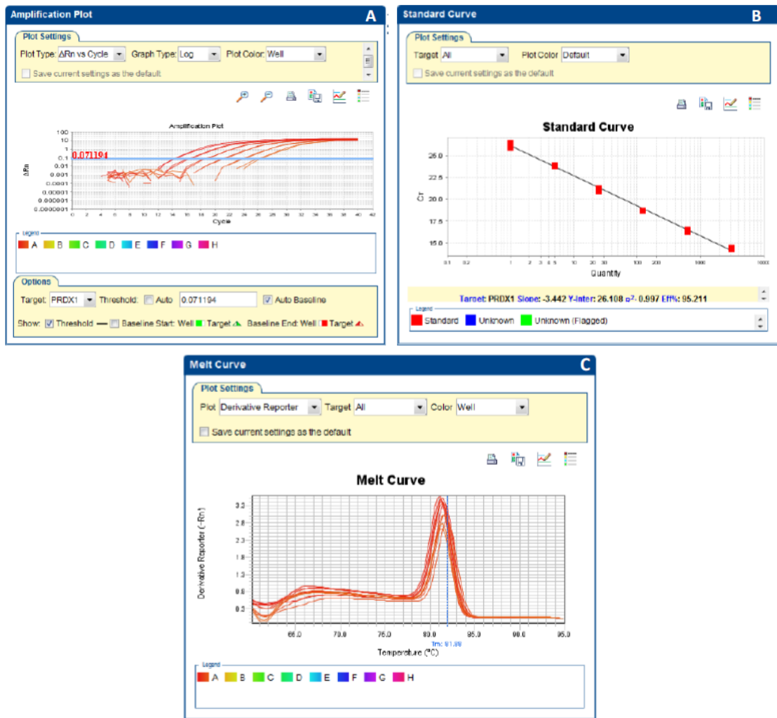
Figura B3 – Teste de eficiência da reação para análise do gene PRDX1
