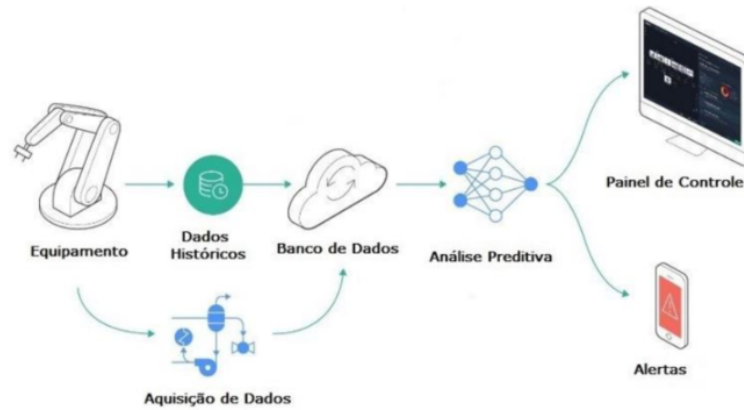
Figura 2: Exemplo esquemático de manutenção preditiva
