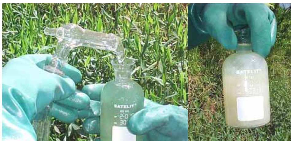
Figura 17. Detalhe da coleta de água para a análise de oxigênio dissolvido.
