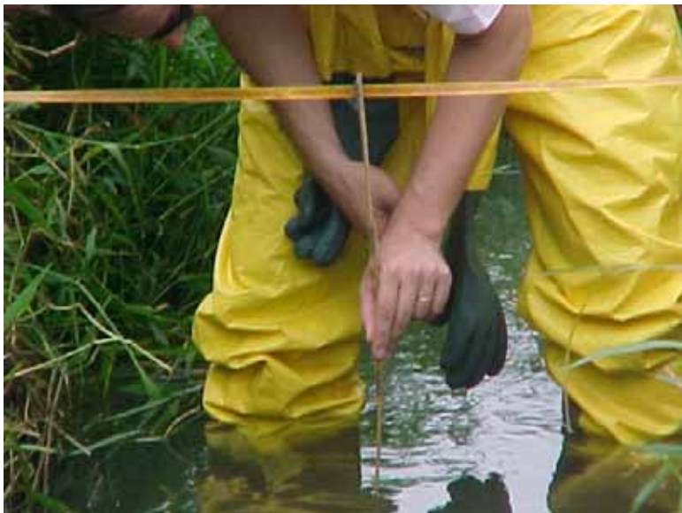
Figura 14. Detalhe da determinação do perfil do canal.
