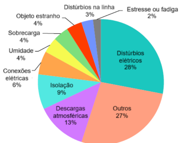
Figura 2 – Causas de falhas em transformadores entre 1991 e 2010.
