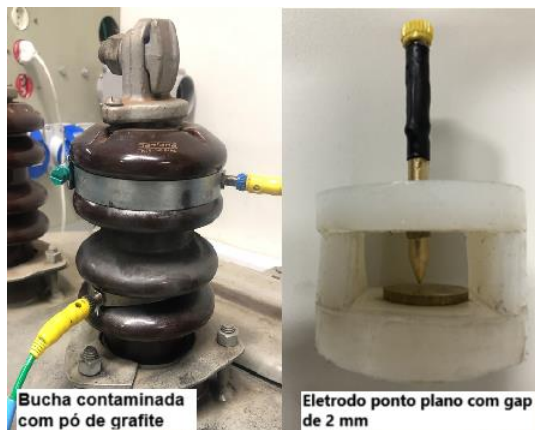
Figura 19 – Eletrodo e bucha utilizados no ensaio laboratorial.
