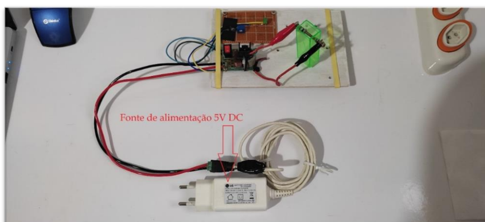
Figura 7 – Fonte de alimentação 5V DC utilizada para alimentar o gerador de alta tensão
