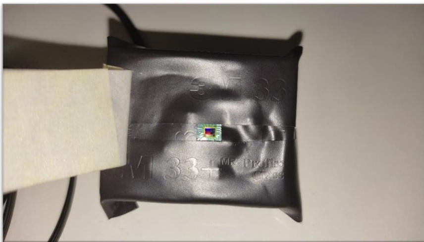
Figura 22 – Fita isolante deixando exposto apenas o sensor CMOS.
