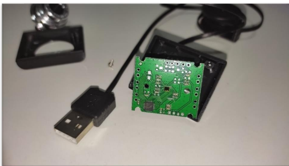
Figura 21 – Webcam sem a lente óptica
