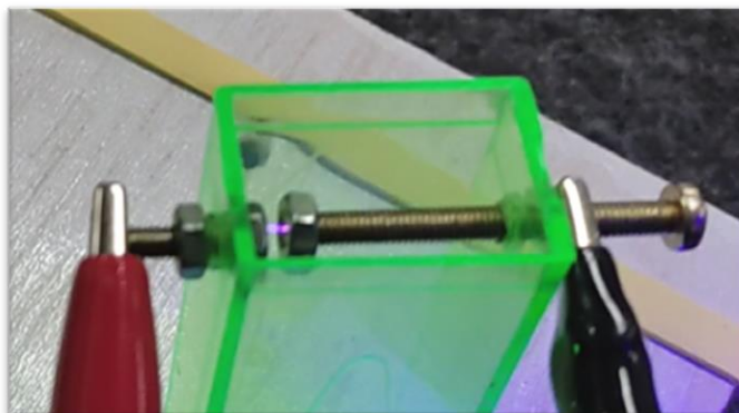
Figura 6 – Centelha entre os terminais
