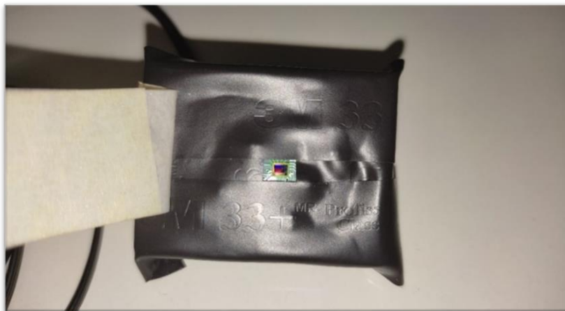
Figura 20– Fita isolante deixando exposto apenas o sensor CMOS.
