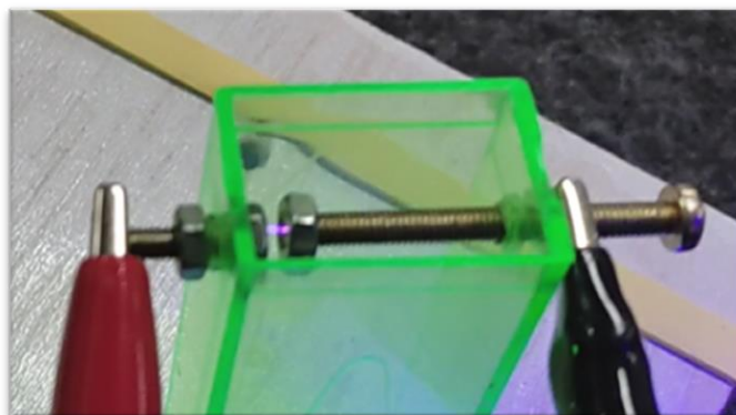
Figura 6 – Centelha entre os terminais
