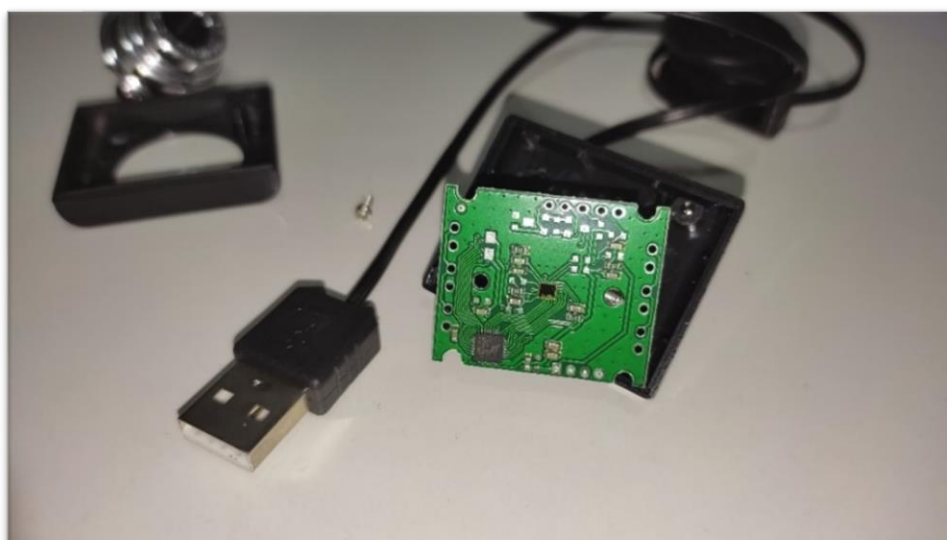
Figura 19– Webcam sem a lente óptica
