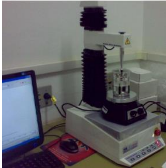
Figura 3. Texturômetro com anel de teste de mucoadesão e aquecedor ( Fonte: SOUZA, 2010).
