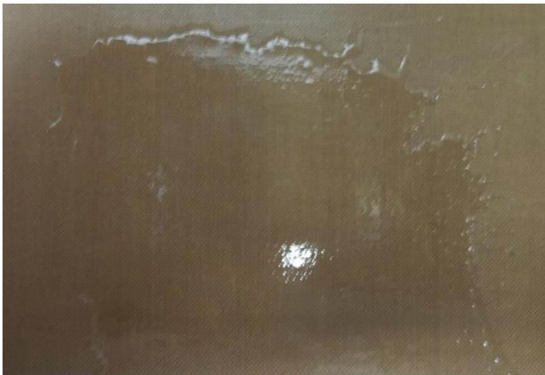
Figura 6. Filme formado a partir do híbrido ureasil-POP 400 etanol, utilizando 300 \mu L de \text{NH}_4\text{F} 0,1M.
