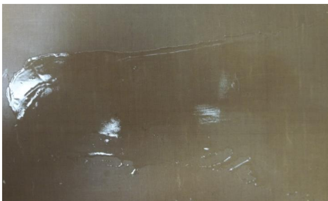
Figura 5. Filme formado a partir do híbrido ureasil-POP 400 etanol, utilizando 18 \mu L de HCl 2M.
