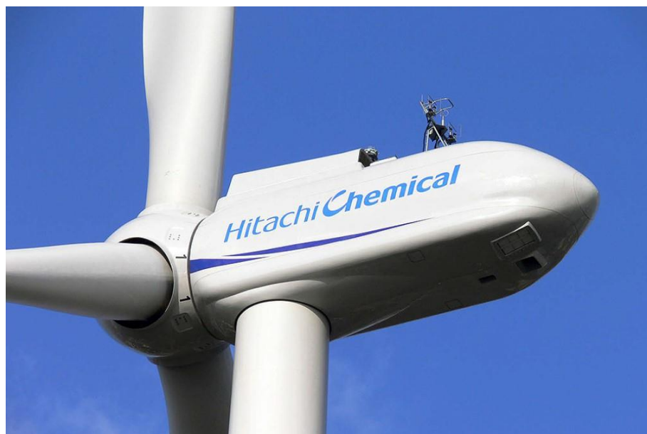
Figura 8 – Exemplo de nacele em aerogerador.
