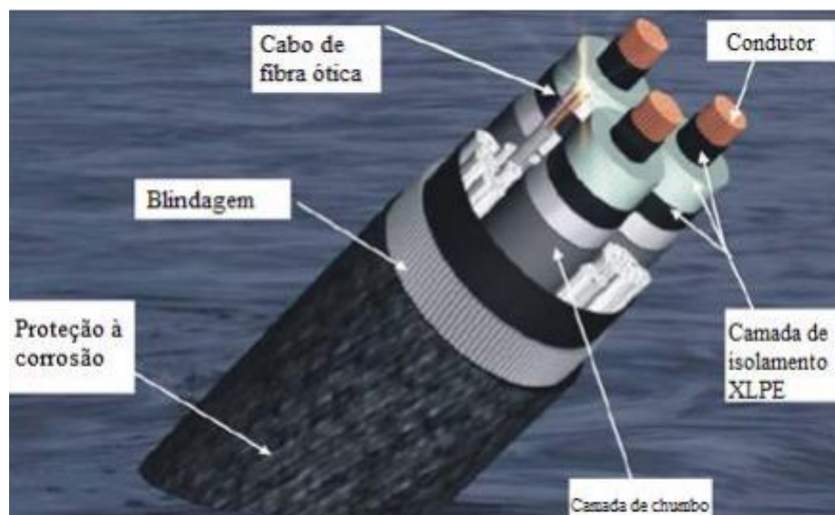
Figura 19 – Cabos de conexões CA, tipo XLPE.
