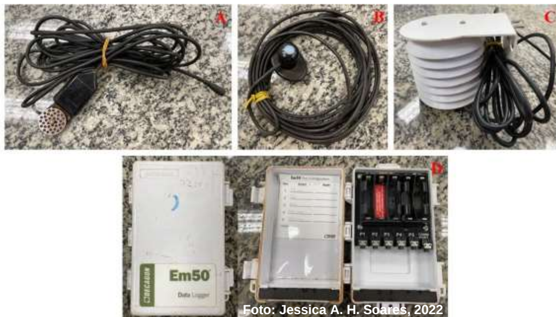
Figura 3 - Data-logger e sensores de microclima e de potencial de água do solo (disponibilidade hídrica do solo) utilizados para a amostragem das variáveis microclimáticas e de disponibilidade hídrica do solo
