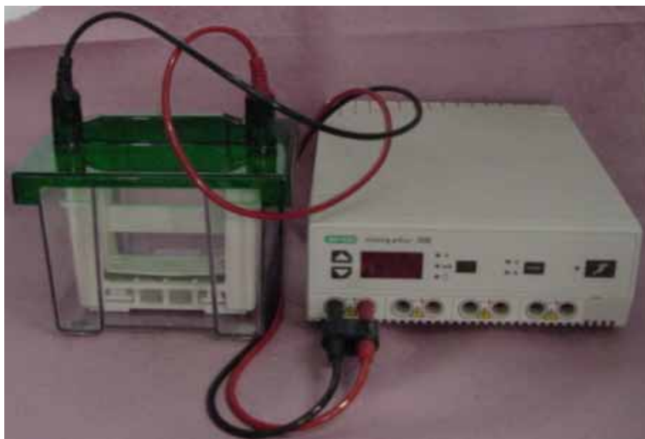
Figura 10: Materiais para eletroforese sob condições não-redutoras. Cuba - Mini Protean® (esquerda) e fonte (direita)
