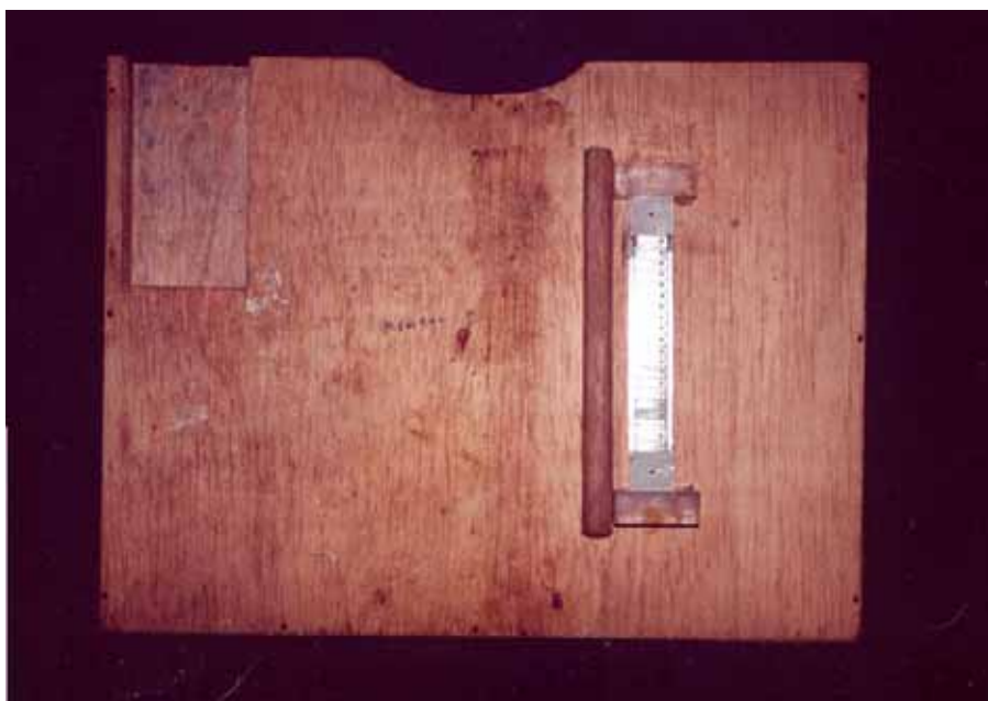
Figura 2: Suporte de madeira acoplado à escala de Alumínio ("phantom").
