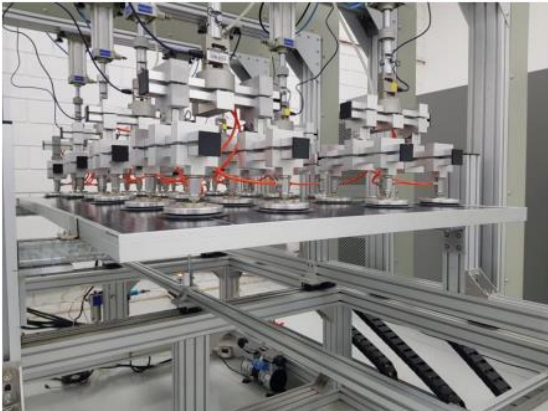
Figura 15: Deformação do módulo para tração 2400 Pa.
