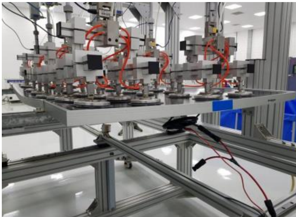
Figura 14: Deformação do módulo para compressão de 5400 Pa.
